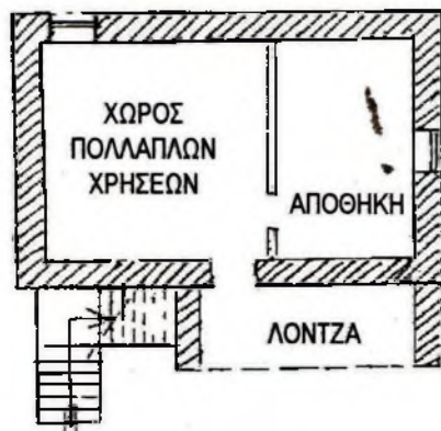
Σχ. 12 - Κάτοψη ορόφου και ισόγειου τρέχωρου δίπατου σπιτιού.
